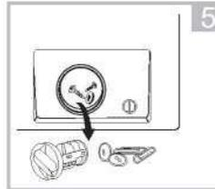
Entfernen Sie alle Fremdkörper und setzen sie den Filter wieder ein
