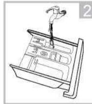
Reinigen Sie die Waschmittellade unter fließendem Wasser.
