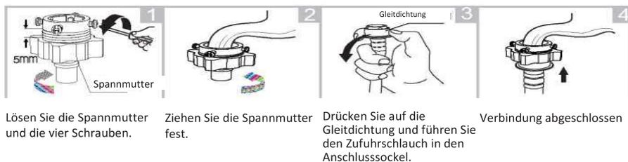
2. Verbindung zwischen Wasserhahn und Zufuhrschlauch
